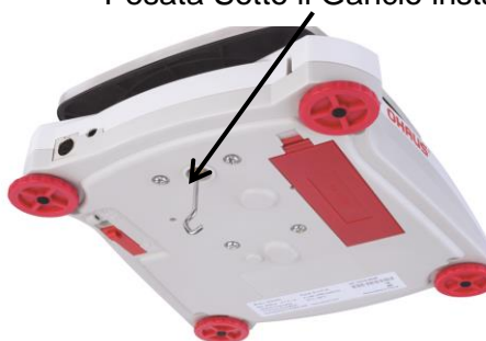
Pesata Sotto il Gancio installato
